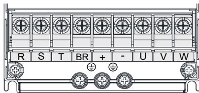
图 3-27 0.4kW~15kW 主回路端子分布图
