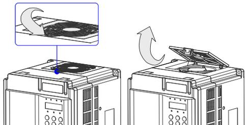
将风扇向上提起后，将电源线插头从插座上拔下，完成拆卸。
