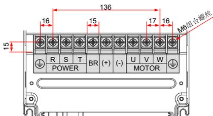
图 3-41 CS710-4T18.5GB(-T)/ CS710-4T22GB(-T) 三相 380V ~ 480V
