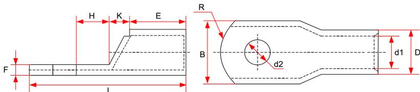
图 9-19 GTNR 系列线耳尺寸图
