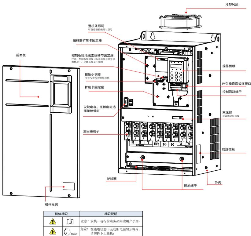
图 1-4 产品部件示意图【三相 380V~480V, 45kW ~ 160kW】
