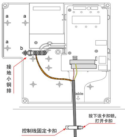
图 3-61 模拟量端子的屏蔽层接地示意图
