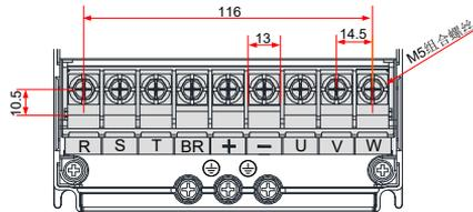
图 3-39 CS710-4T7.5GB/CS710-4T11GB 三相 380V ~ 480V 主回路端子尺寸
