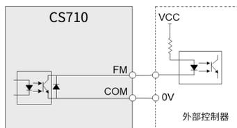
图 3-68 高速数字输出端子接线示意图
