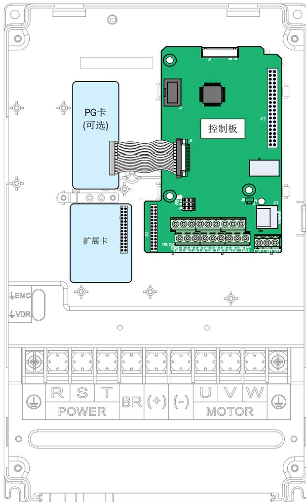
图 3-56 CS710 控制板安装位置示意图
