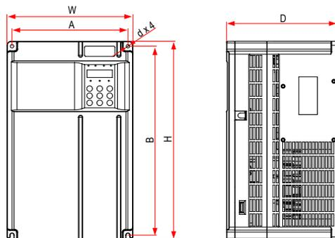
图 9-2 18.5kW~37kW 外型尺寸及安装尺寸示意图
