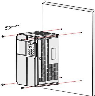
图 3-7 0.4kW~37kW 机型壁挂式安装示意图
