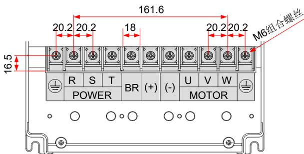
图 3-42 CS710-4T30GB/ CS710-4T37GB 三相 380V ~ 480V
