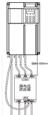
图 B-2 简易滤波器安装示意图
