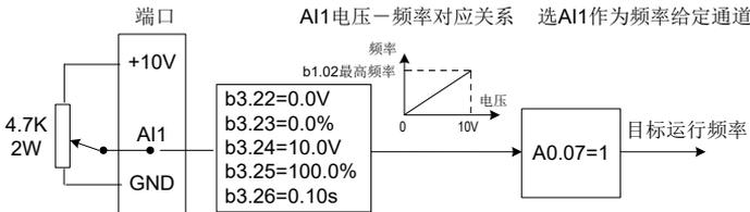
图 5-7 模拟量给定频率设置
