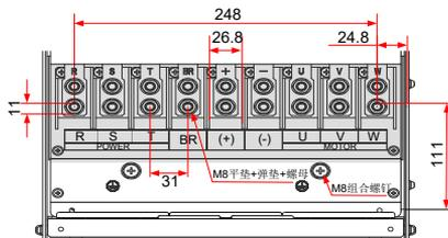
图 3-43 CS710-4T45GB/ CS710-4T55GB 三相 380V ~ 480V
