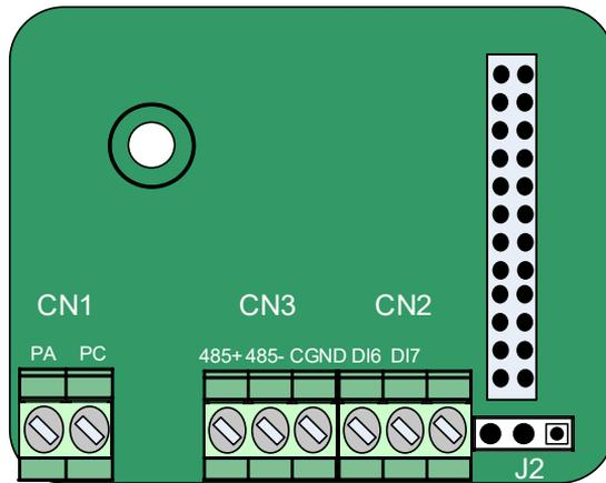
图 10-4 CS700IO1 端子分布示意图
