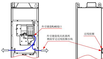
图 3-71 外引操作面板线缆走线示意图
