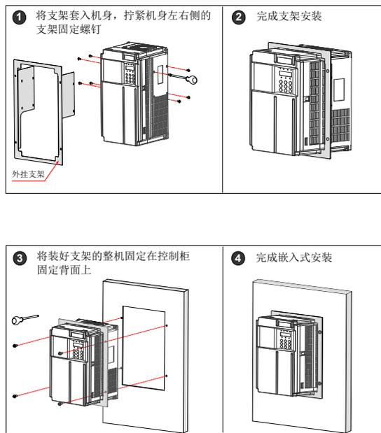
图 3-9 0.4kW~37kW 机型嵌入式安装示意图
