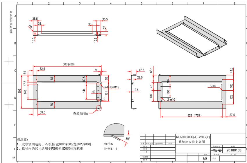
图 9-15 200kW ~ 220kW 安装支架尺寸 (出厂标配)
