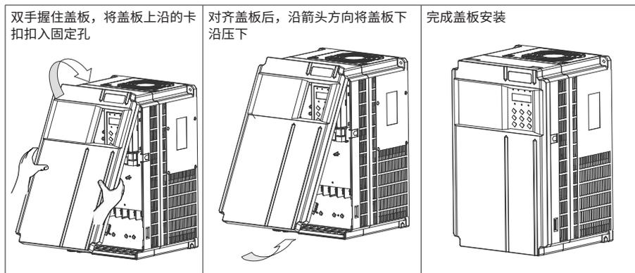
图 3-23 0.4kW~37kW 机型盖板拆卸与安装
