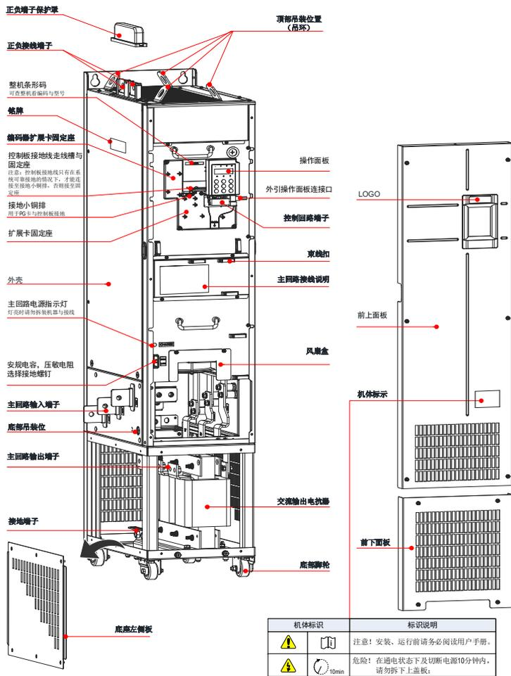
图 1-6 产品部件示意图 【三相 380V~480V, 200kW-L ~ 450kW-L】
