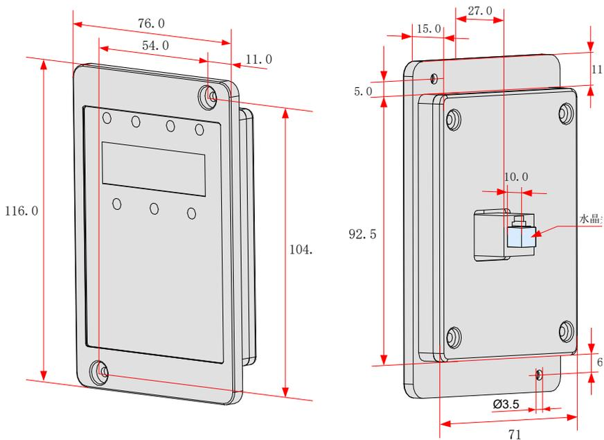
图 9-23 外引操作面板尺寸（单位：mm）
