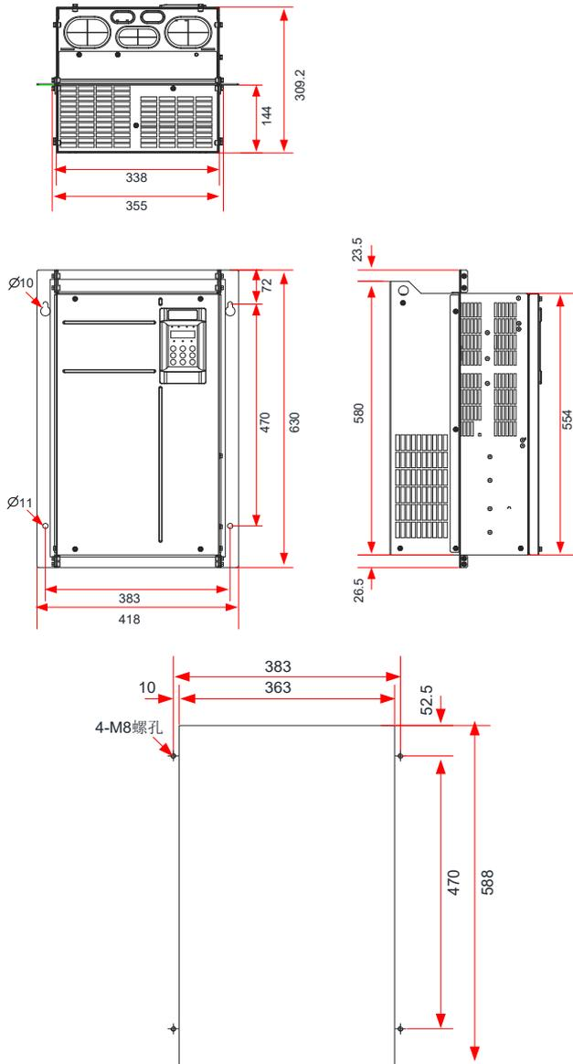
图 9-11 75kW ~ 110kW 中部安装支架及开孔尺寸
