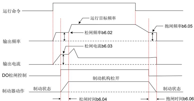
图 5-9 起重系统典型控制工艺及功能码
