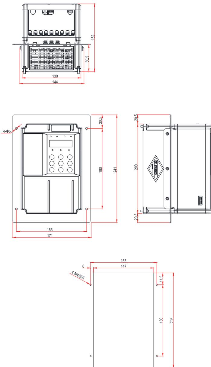
图 9-4 0.4kW ~ 3.0kW 中部安装支架及开孔尺寸
