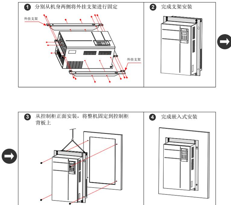
图 3-10 45kW~160kW 机型嵌入式安装示意图
