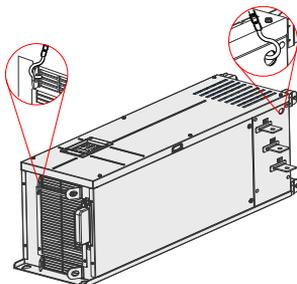
如需垂直放置，请避免机器侧面受力或将机器放置于倾斜的面上，产品体积较大且重量较重（接近 200kg），如果倾斜超过 5°，很可能发生侧翻。这样可能会导致机器倾倒。
