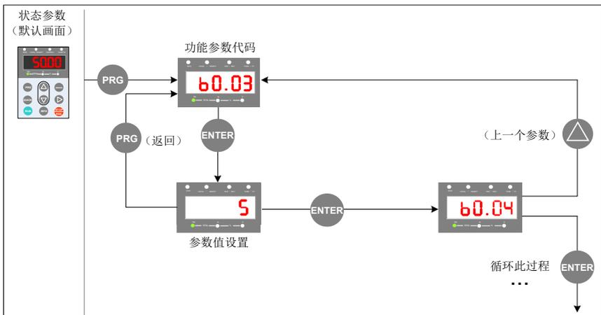
图 4-3 不同界面操作流程图
