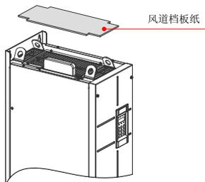
请使用产品顶部的吊环进行吊装及移动，如需平躺放置，再次吊起时请使用机器顶部和底部的吊装件，但正负母线端子禁止受力：
