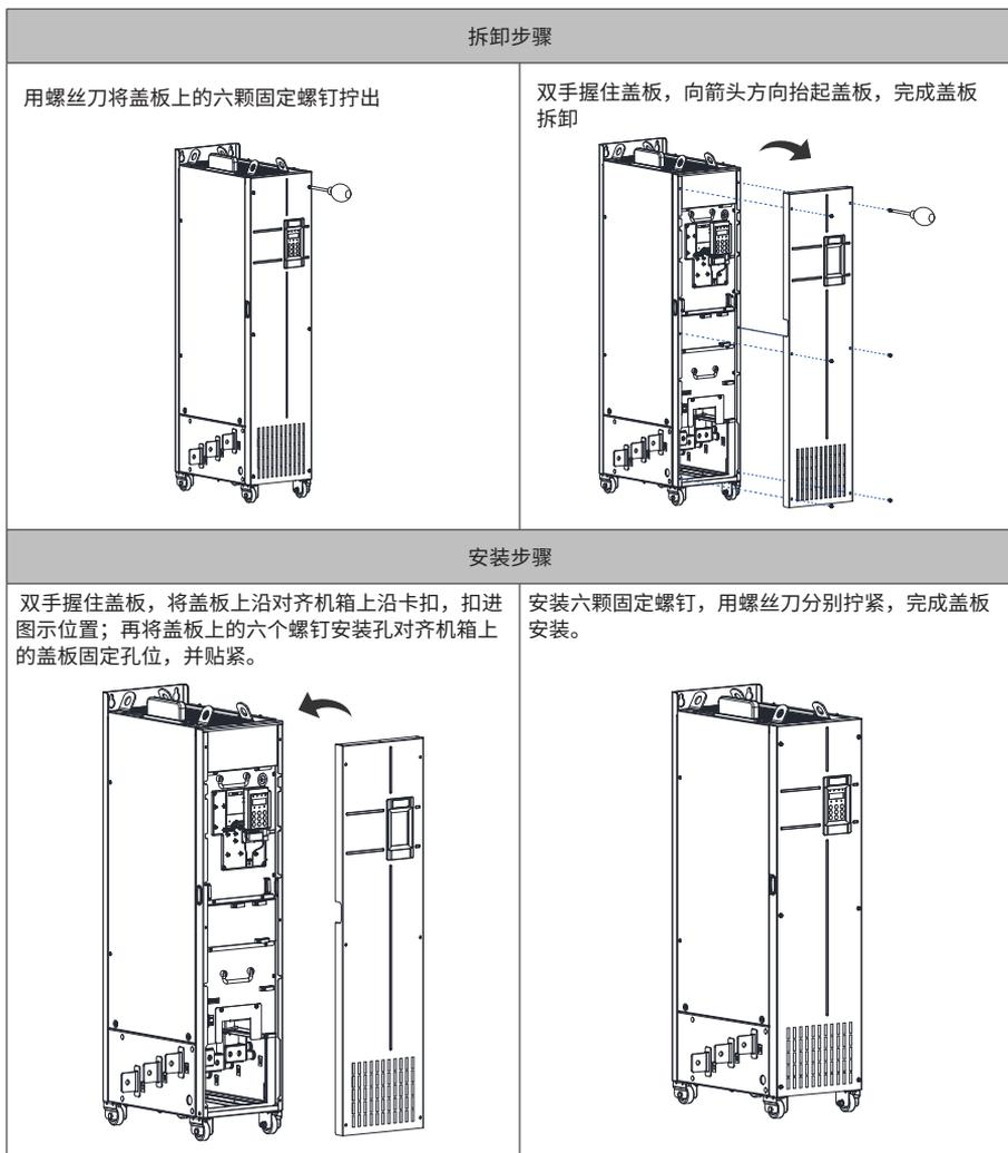
图 3-25 200kW~450kW 机型盖板拆卸与安装
