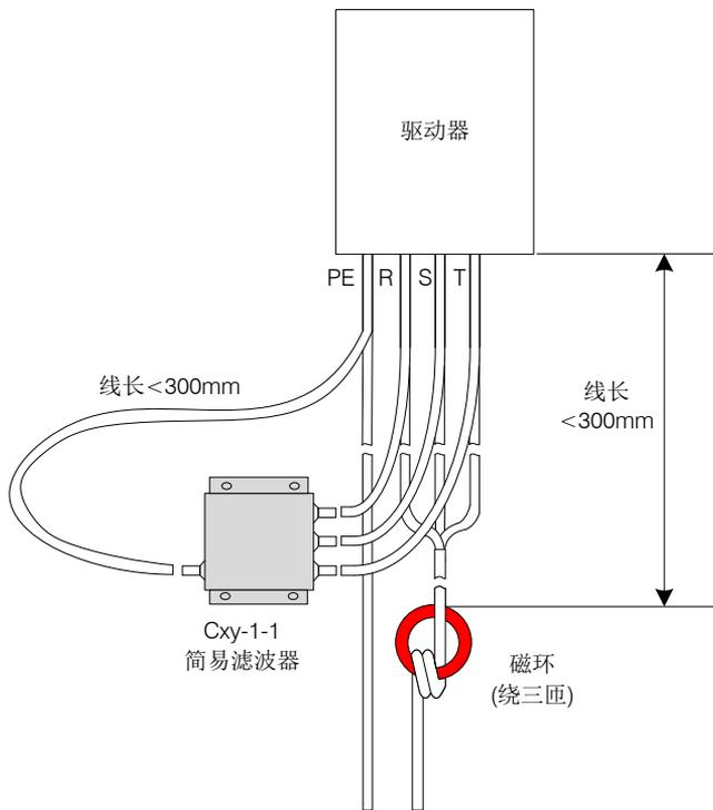
图 9-22 输入侧加装简易滤波器、磁环
