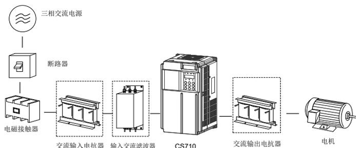
图 B-1 EMC 外围配件安装示意图（虚线框所示）
