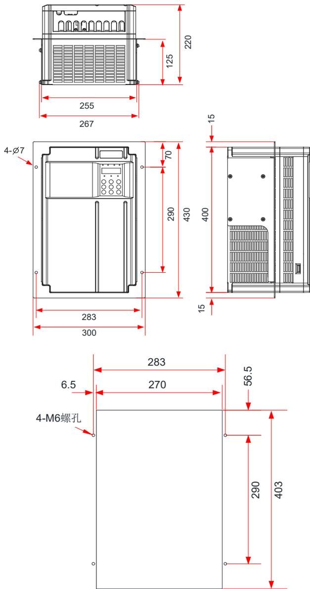
图 9-9 30kW ~ 37kW 中部安装支架及开孔尺寸
