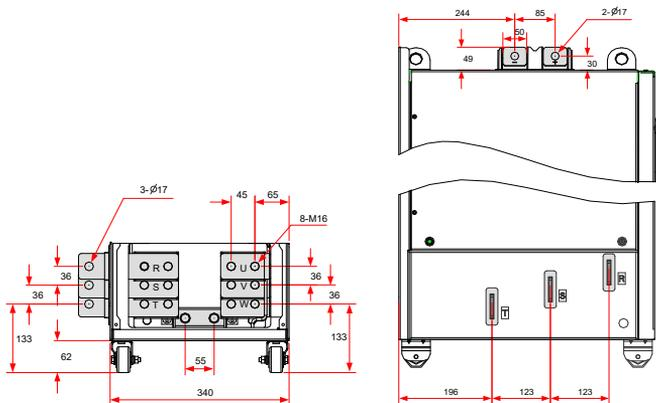
图 3-52 CS710-4T315G- CS710-4T450G 主回路端子尺寸（不带输出电抗器）
