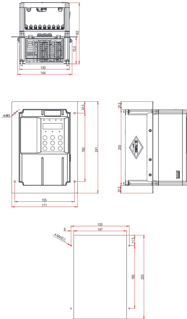
图 9-5 3.7kW ~ 5.5kW 中部安装支架及开孔尺寸
