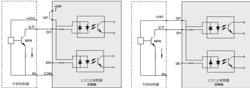
图 3-63 漏型接线方式
