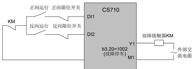
图 5-10 安全限位及故障停车应用接线图
