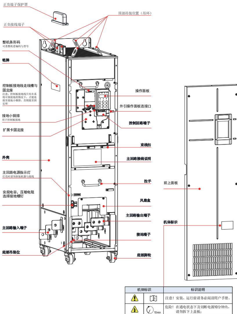
图 1-5 产品部件示意图【三相 380V~480V，200kW ~ 450kW】
