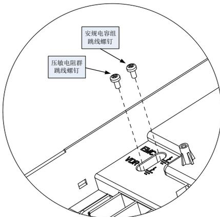
图 B-8 安规电容组跳线位置示意图
