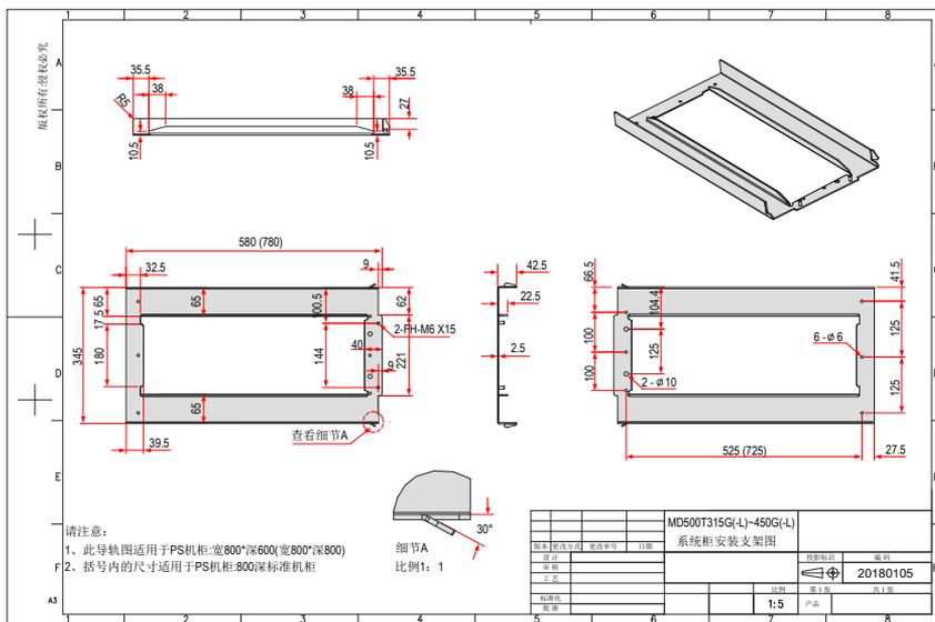
图 9-17 315kW ~ 450kW 安装支架尺寸 (出厂标配)
