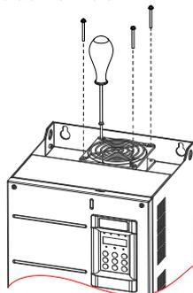
将风扇罩、风扇脱离机体，完成风扇拆卸
