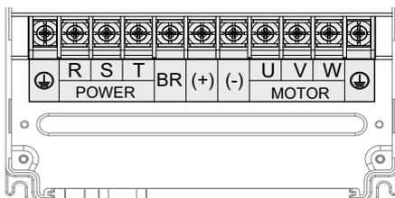
图 3-28 18.5kW~160kW 主回路端子分布图
