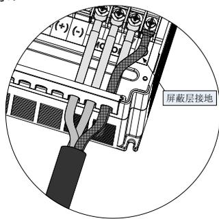
图 B-6 屏蔽电缆接地示意图
