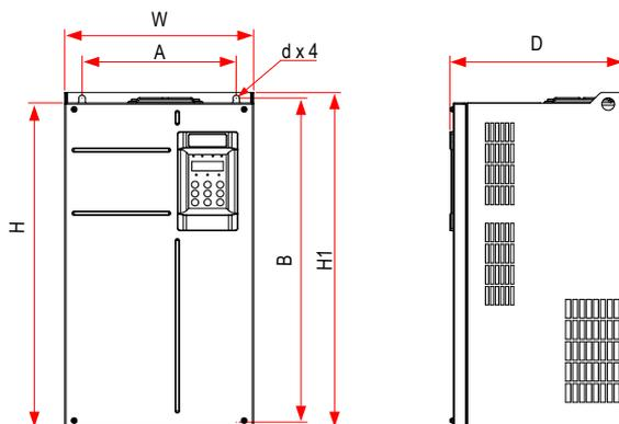
图 9-3 45kW~160kW 外型尺寸及安装尺寸示意图
