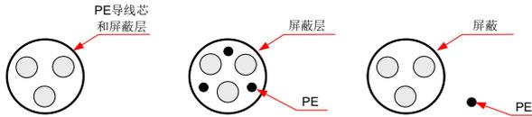
图 3-30 推荐的动力电缆类型
