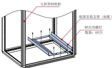
图 3-17 底部安装支架安装示意图
