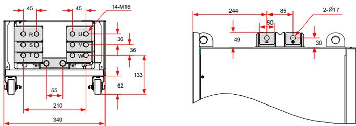
图 3-54 CS710-4T315G-CS710-4T450G 主回路端子尺寸（不带侧出铜排，不带输出电抗器）
