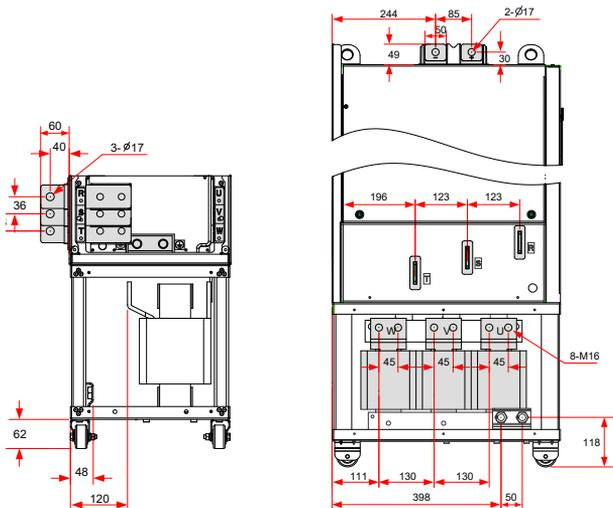
图 3-53 CS710-4T315G-L- CS710-4T450G-L 主回路端子尺寸（带输出电抗器）
