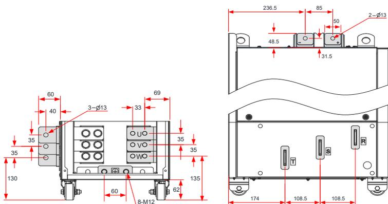
图 3-46 CS710-4T200G/ CS710-4T220G 主回路端子尺寸 (不带输出电抗器)
