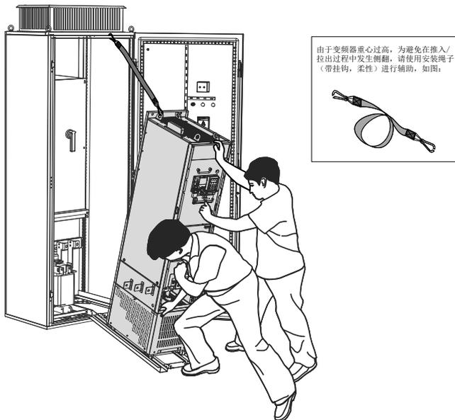
图 3-20 将变频器缓缓推入机柜
