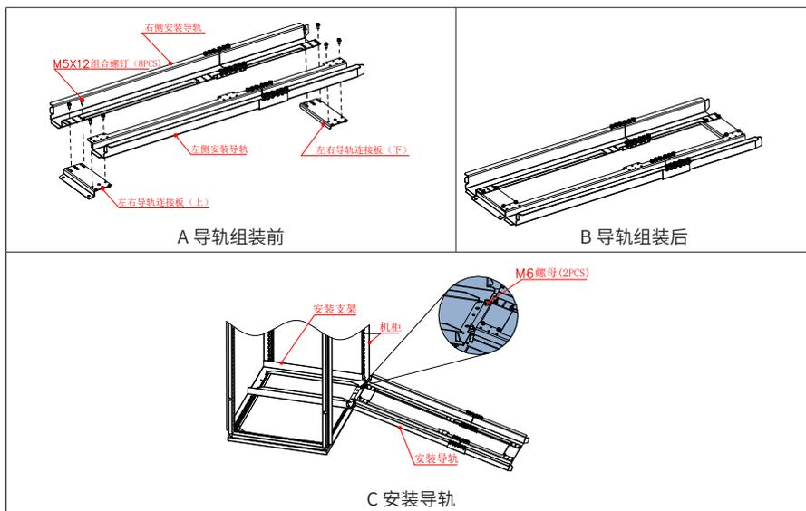
图 3-18 安装导轨机柜内的安装示意图
