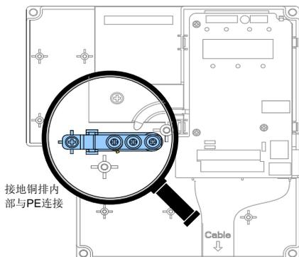
CS710 在结构上进行了整机接地处理，在完成 PG 卡安装后，可实现与 PG 卡 PE 端子的内部连接；进行编码器接线时，只需将信号线的屏蔽层引出后接入该 PG 卡上的 PE 端子，即可完成信号线的屏蔽层接地。
