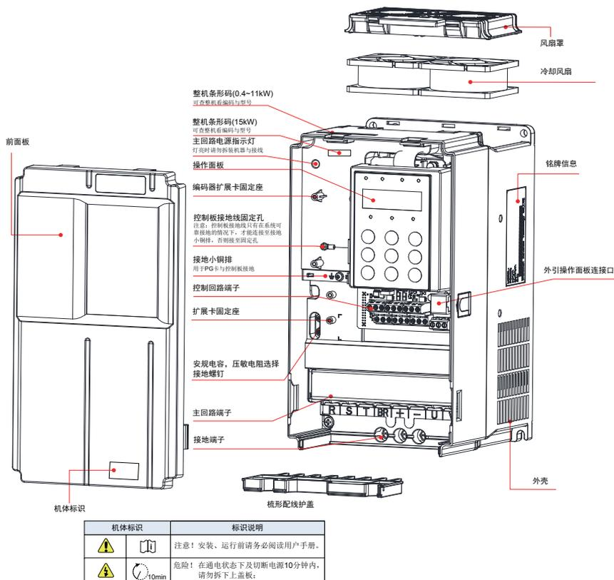
图 1-2 产品部件示意图【三相 380V~480V 0.4kW ~ 15kW】
