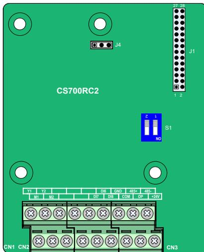
图 10-5 CS700RC2 端子分布示意图
