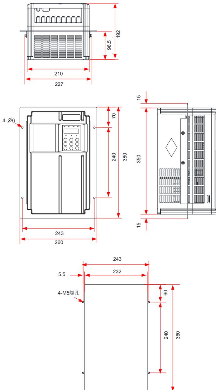
图 9-8 18.5kW ~ 22kW 中部安装支架及开孔尺寸
