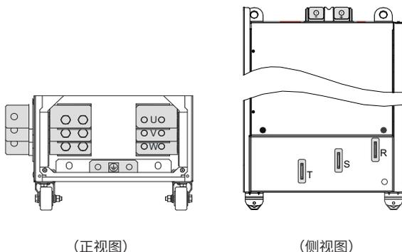
图 3-29 200kW~450kW 主回路端子分布图
