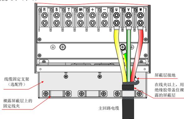
图 3-33 屏蔽层接线
