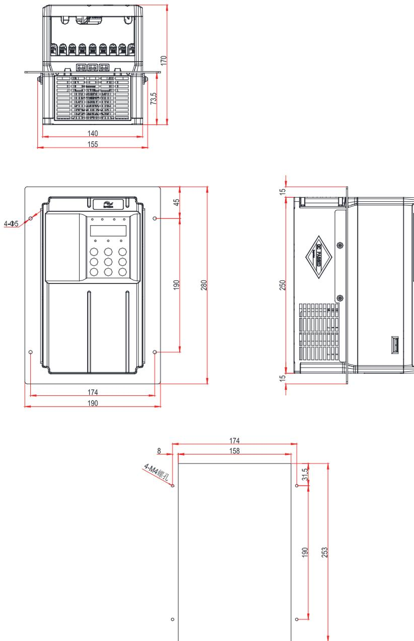
图 9-6 7.5kW ~ 11kW 中部安装支架及开孔尺寸
