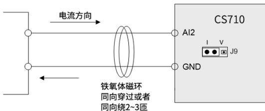
图 3-62 模拟量 AI2 输入端子处理接线图
