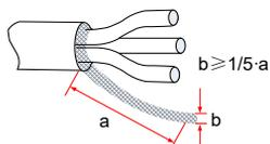
图 3-35 机电缆屏蔽层引出示意图
