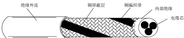
图 B-5 屏蔽电缆屏蔽层示意图
