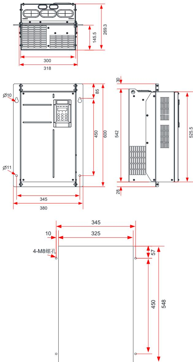
图 9-10 45kW ~ 55kW 中部安装支架及开孔尺寸
