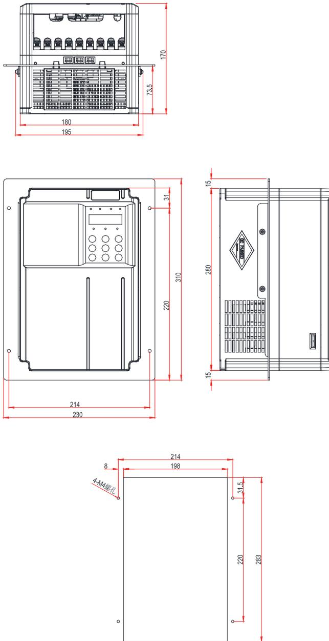
图 9-7 15kW 中部安装支架及开孔尺寸
