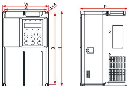
图 9-1 0.4kW~15kW 外型尺寸及安装尺寸示意图
