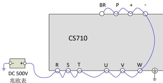
图 8-1 主回路绝缘测试示意图
