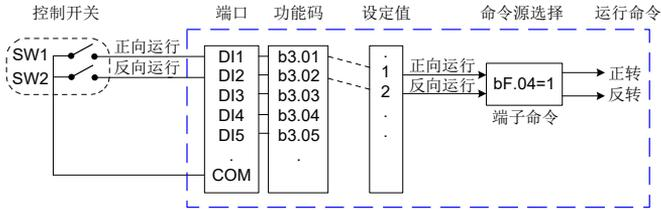
图 5-2 端子启停控制方式举例
