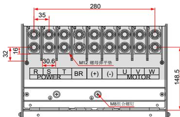
图 3-44 CS710-4T75GB~CS710-4T110G 三相 380V ~ 480V
