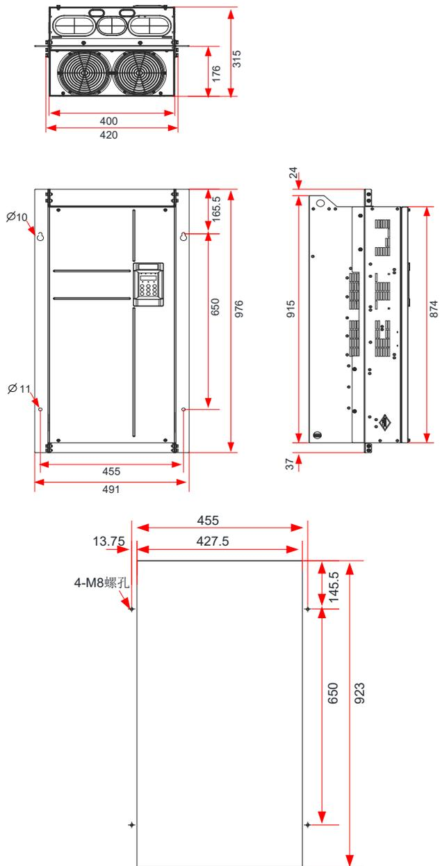
图 9-12 132kW ~ 160kW 中部安装支架及开孔尺寸
