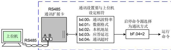
图 5-3 通讯启停控制方式举例
