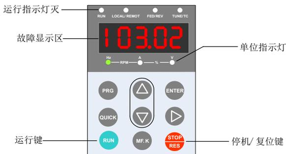
图 7-2 故障记录界面 LED 显示举例
