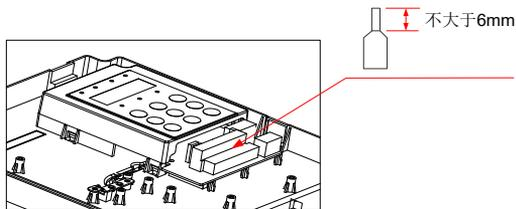
图 3-70 控制线管状端子要求
