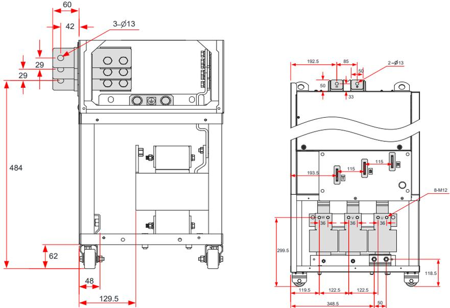
图 3-50 CS710-4T250G-L/ CS710-4T280G-L 主回路端子尺寸（带输出电抗器）
