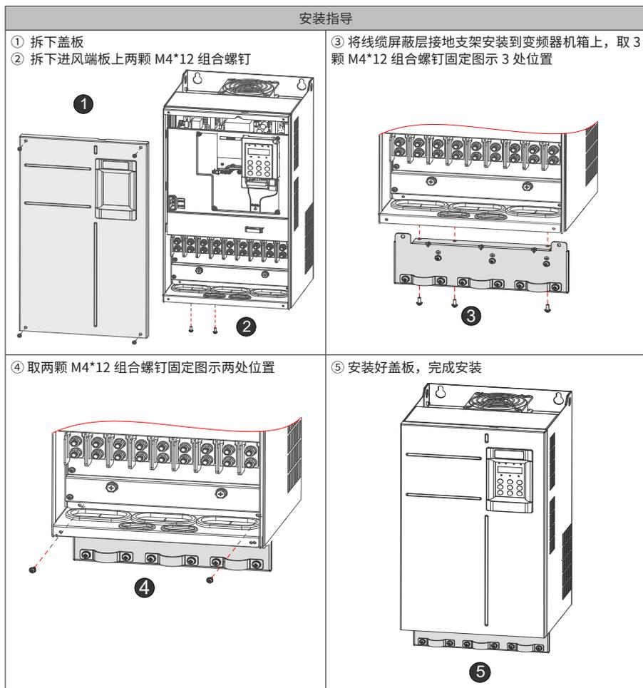
图 3-34 线缆屏蔽层接地支架安装示意图
