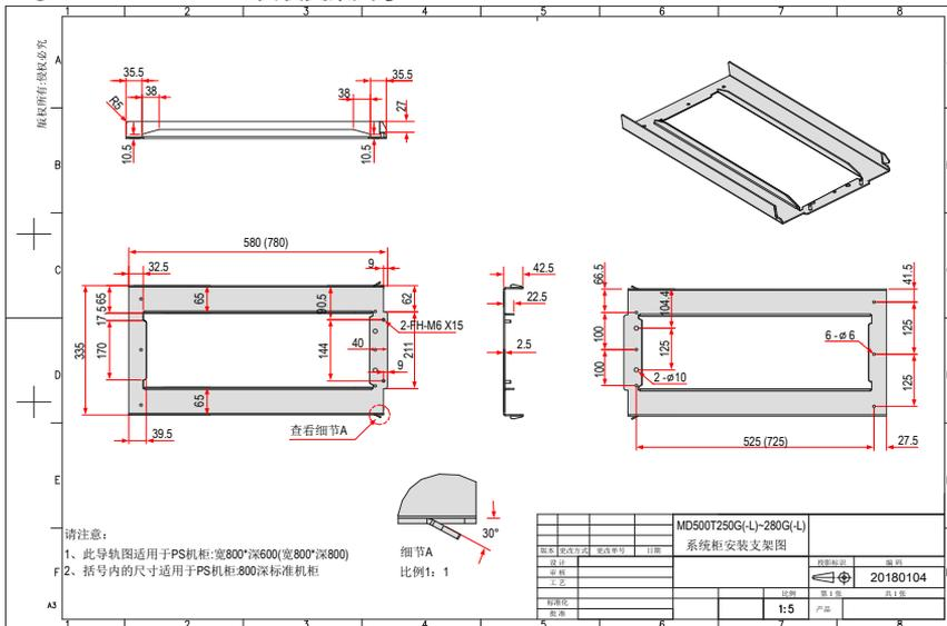
图 9-16 250kW ~ 280kW 安装支架尺寸 (出厂标配)
