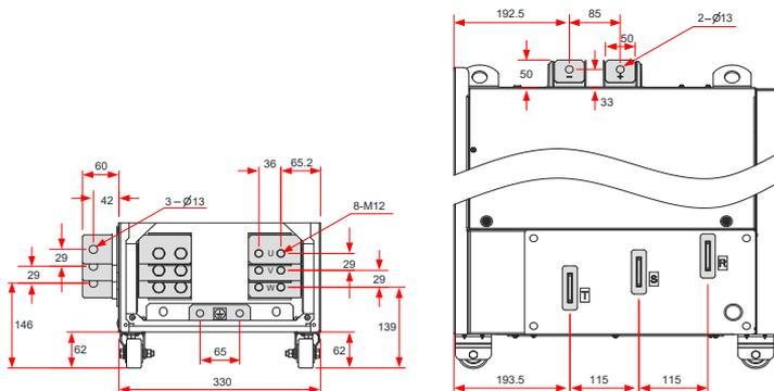
图 3-49 CS710-4T250G/ CS710-4T280G 主回路端子尺寸（不带输出电抗器）
