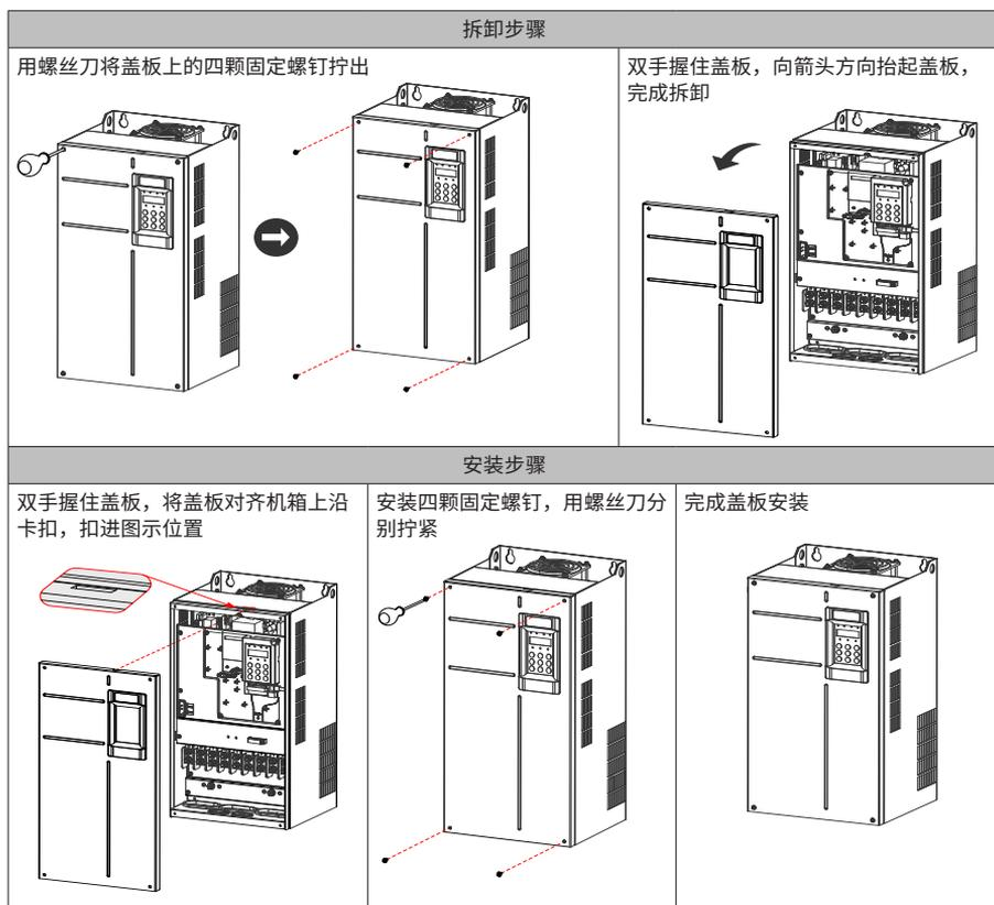
图 3-24 45kW~160kW 机型盖板拆卸与安装
