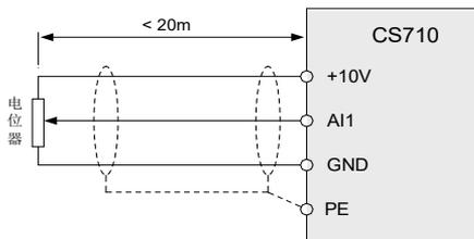
图 3-60 模拟量输入端子接线示意图
