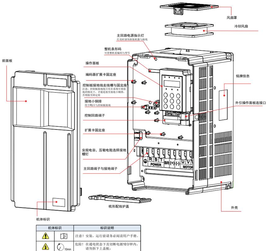
图 1-3 产品部件示意图【三相 380V~480V，18.5kW ~ 37kW】
