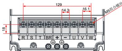
图 3-40 CS710-4T15GB 三相 380V ~ 480V 主回路端子尺寸
