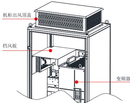
图 3-13 机柜挡风板示意图
