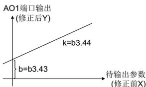
图 5-8 AO1 端口输出特性曲线
