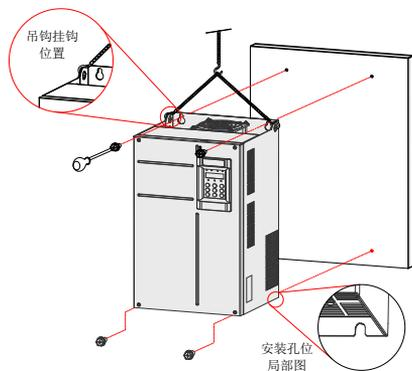
图 3-8 45kW~160kW 机型壁挂式安装示意图
