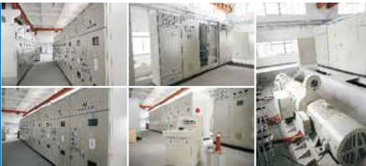
用于自主研发，国内领先的变频器负载专用试验站，保证产品出厂前的 100% 进行全电压满载老化试验。
