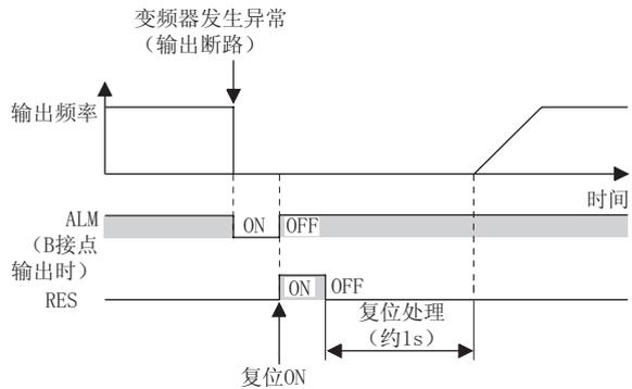
②根据变频器运转准备完成信号检查变频器的工作状态
