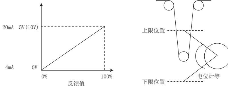
(例) 使用0~7V的电位计，以浮动辊中心位置进行控制时
