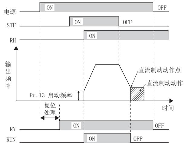
③根据输入变频器的启动信号和变频器的运转中信号检查变频器的运转状态
