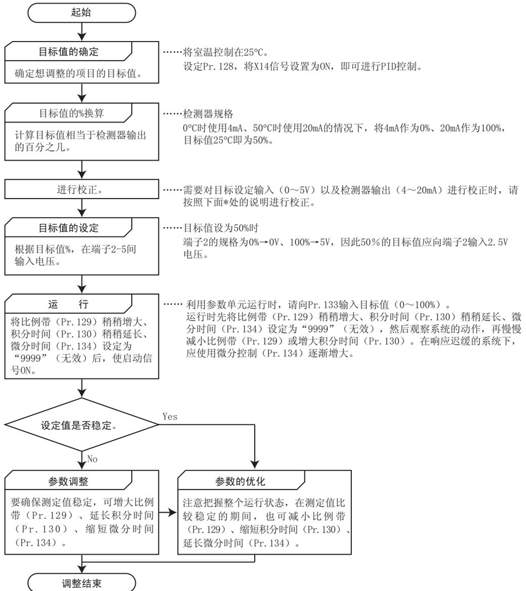
\*需要校正时→通过Pr. 902及Pr. 903 (端子2)或Pr. 904及Pr. 905 (端子4)对检测器输出和目标设定输入进行校正。
