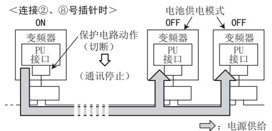
使用通过变频器供电的RS-485转换器时，请确保只通过1台变频器供电。（参照下图）
