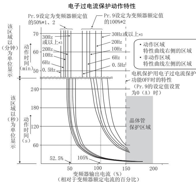
检测到电机的过载（过热）后，停止变频器的输出晶体管的动作并停止输出。（动作特性如左图所示）
