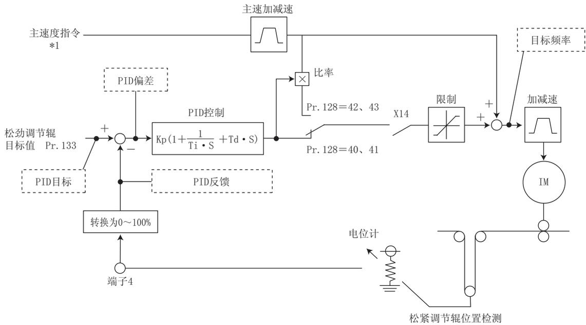
\*1 主速度可以从外部（模拟电压输入、多段速）、PU（数字频率设定）、通讯（RS-485）的所有运行模式中选择。
