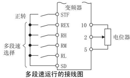
\*1 如果设定Pr. 232 多段速设定 (8速) = “9999” 时，将RH、RM、RL设为OFF、REX设为ON时，将按照Pr. 6的频率动作。
