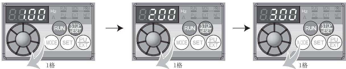
\*M旋钮旋转1圈为24个移动量。
