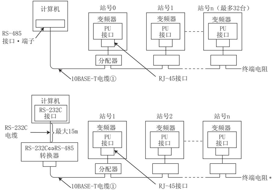
\* 有时会由于传送速度、距离而受到反射的影响。当反射影响到通讯时，请安装终端电阻。使用PU接口进行连接时不能安装终端电阻，请使用分配器。终端电阻请只与离计算机最远的变频器连接。（终端电阻：100Ω）
