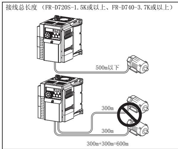
400V系列的电机用变频器驱动时，线路参数引起的浪涌电压在电机的端子侧发生，此电压会使电机的绝缘性能降低。这种情况下请参照第41页。
