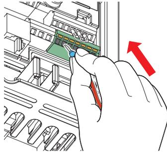
绞线状态且未使用棒状端子时，请用一字螺丝刀将开关按钮按入深处，然后再插入电线。
