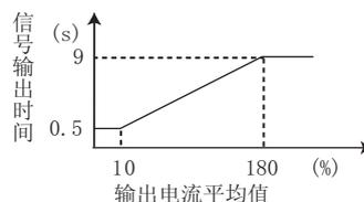
④ Pr. 503 维护定时器的输出
