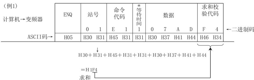
\*设定Pr. 123“等待时间设定” ≠ 9999时，制作通讯请求数据时请将数据格式设为无“等待时间”。(字符数减少1位。)
