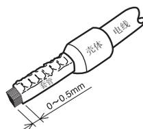
压接后，确认棒状端子的外观。未正确压接或侧面有损伤的棒状端子请不要使用。
